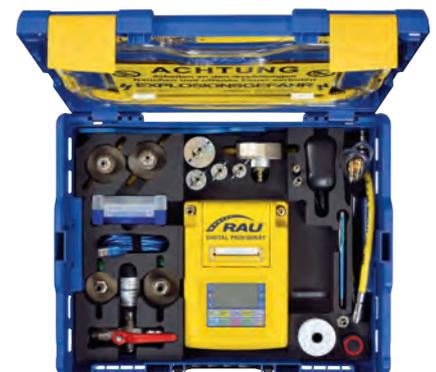
Übersichtliche Anordnung der Prüfadapter, welche mit Pneumatik-Kupplungen zusammengesteckt werden können. (Abb. enthält Sonderzubehör)
