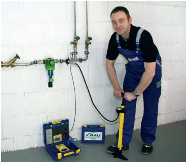
Belastungsprüfung mit Medium Luft, Druckaufbau mit optionaler Druckpumpe DPL Art.-Nr. 332
