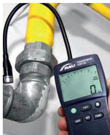
**Bild links:** Überprüfung nach Zählermontage
