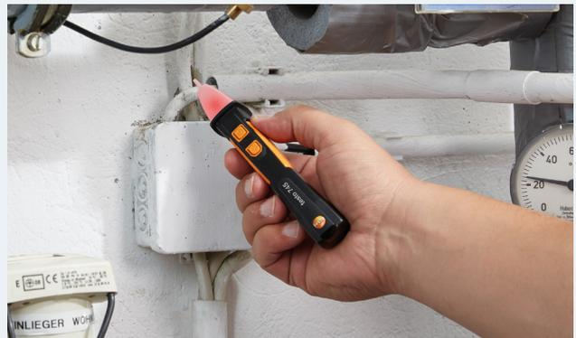
Kontaktlose Spannungsprüfung an einer Verteilerdose zu einer Heizungsanlage mit dem testo 745.
