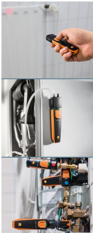
Die Testo Smart Probes übertragen Messwerte per Bluetooth an die testo Smart Probes App auf Ihrem Smartphone/Tablet. Hier können Sie die Daten analysieren, dokumentieren und direkt vor Ort als E-Mail-Protokoll versenden.
